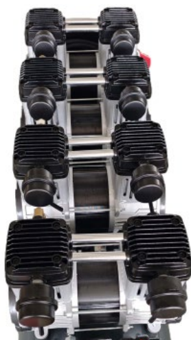
Obr. 9 - Umístění vzduchových filtrů
